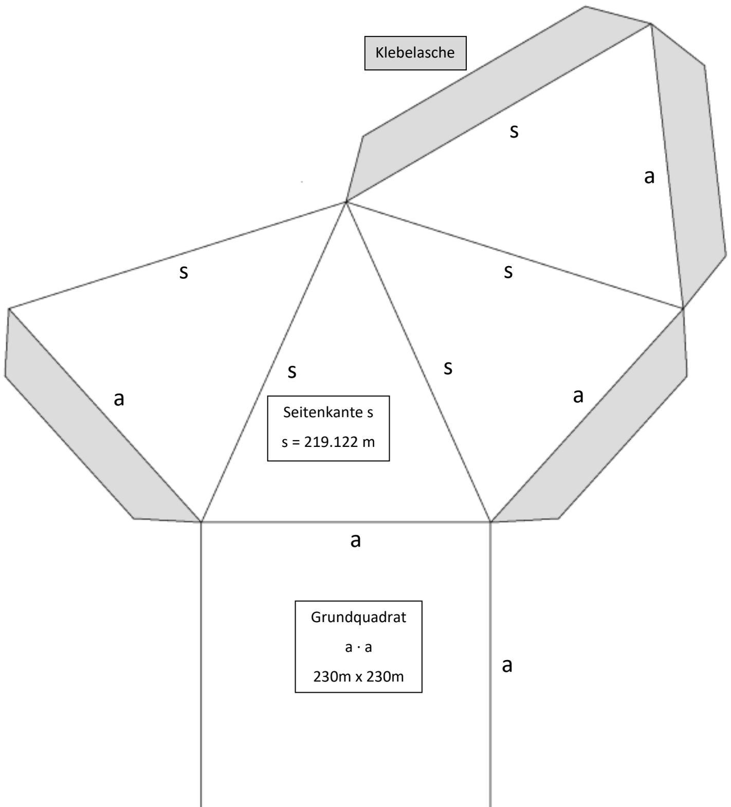
Die Basis-Länge  $a$  wird im Modell  $7.42\text{cm}$ , die Seitenkante  $s$  ist  $7.07\text{cm}$ .
